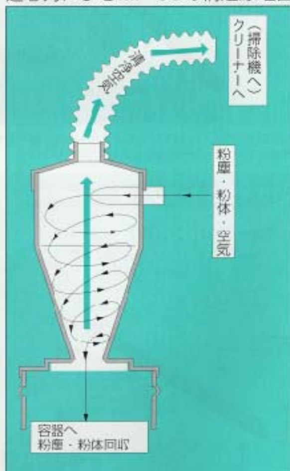
遠心力によるMP-38の構造原理図
