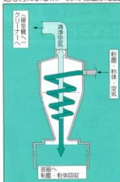
遠心力によるMP-38の構造原理図
